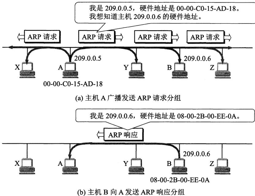
图 4-11 地址解析协议 ARP 的工作原理
