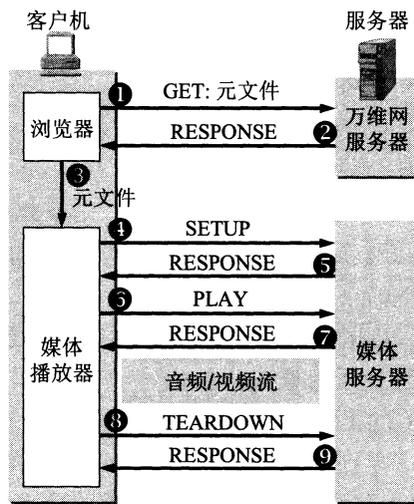
图 8-8 使用 RTSP 的媒体服务器的工作过程
