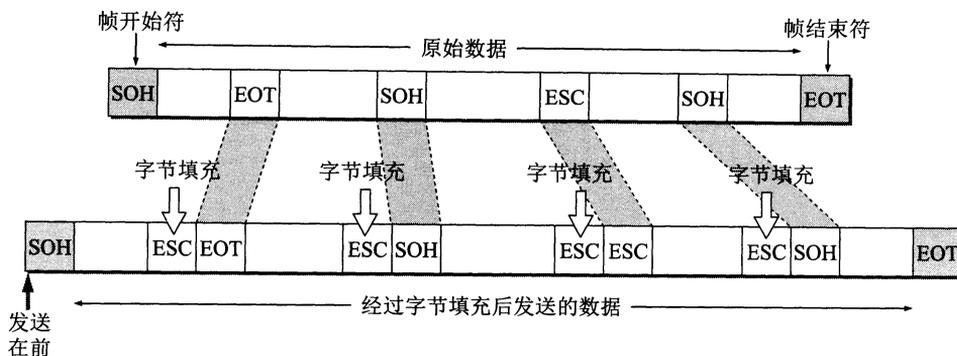
图 3-7 用字节填充法解决透明传输的问题
