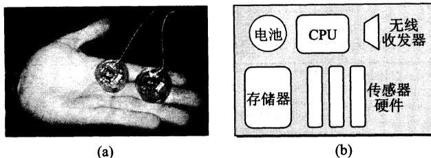
图 9-3 传感器结点的形状(a)和组成(b)
