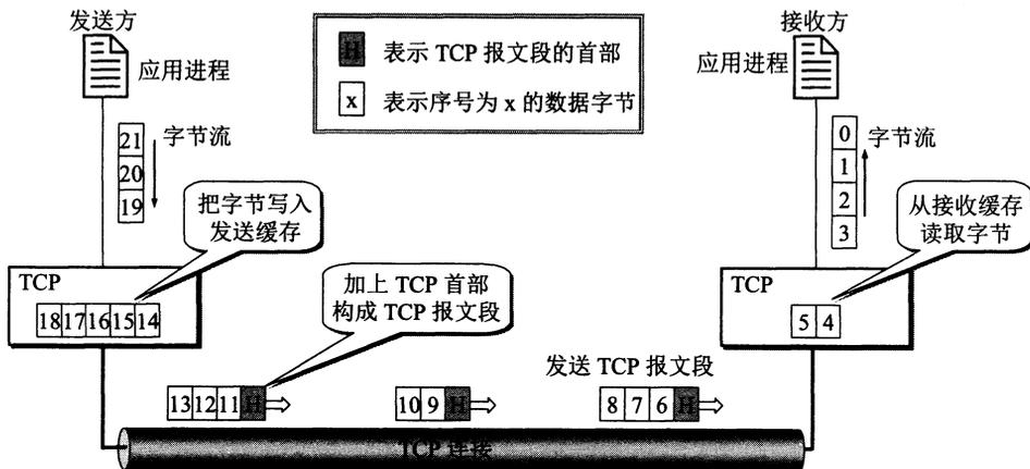
图 5-8 TCP 面向字节流的概念
