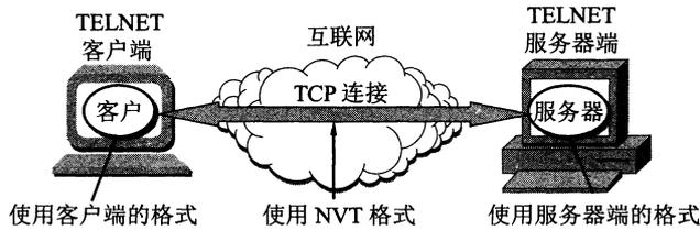
图 6-7 TELNET 使用网络虚拟终端 NVT 格式
