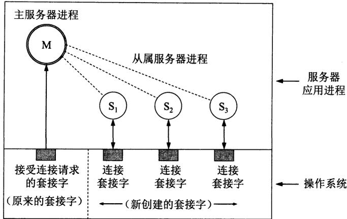
图 6-30 并发方式工作的服务器
