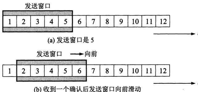
图 5-13 连续 ARQ 协议的工作原理
