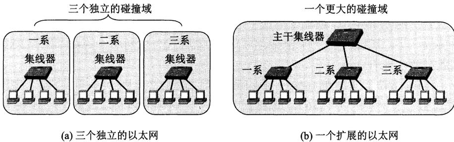
图 3-24 用多个集线器连成更大的以太网
