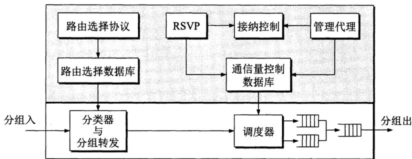
图 8-25 IntServ 体系结构在路由器中的实现
