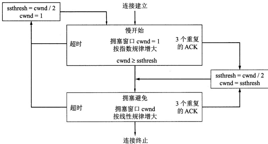
图 5-27 TCP 的拥塞控制的流程图
