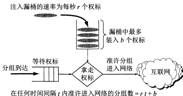
图 8-22 漏桶管制器的工作原理
