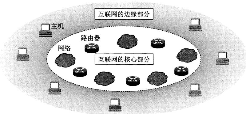
图 1-6 互联网的边缘部分与核心部分
