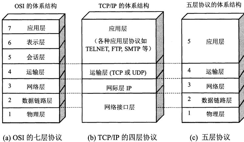
图 1-18 计算机网络体系结构
