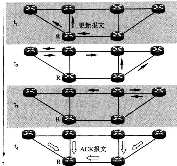
图 4-37 用可靠的洪泛法发送更新分组
