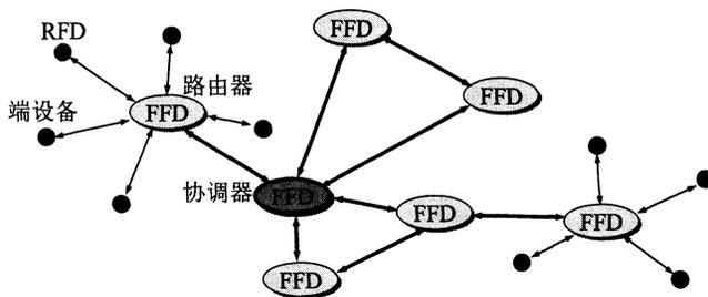
图 9-15 ZigBee 的组网方式
