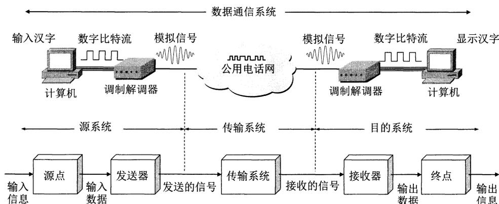
图 2-1 数据通信系统的模型
