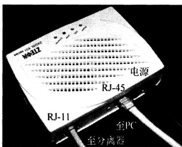
图 2-21 ADSL 调制解调器(ADSL ATU-R)
