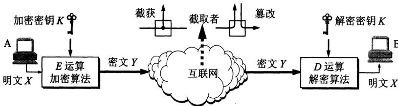
图 7-2 一般的数据加密模型
