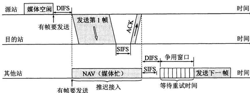
图 9-6 CSMA/CA 协议的工作原理
