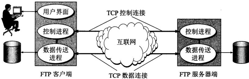
图 6-6 FTP 使用的两个 TCP 连接
