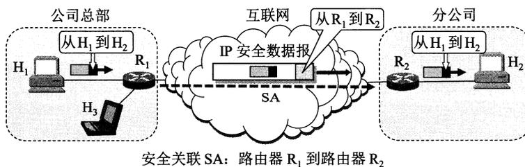
图 7-13 安全关联 SA 的示意图
