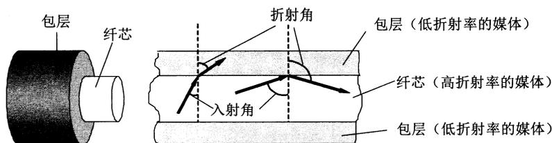
图 2-8 光线在光纤中的折射
