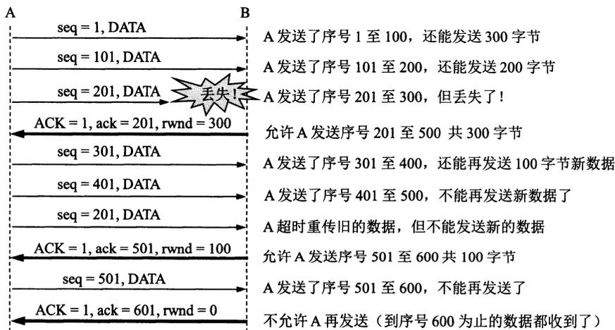
图 5-22 利用可变窗口进行流量控制举例
