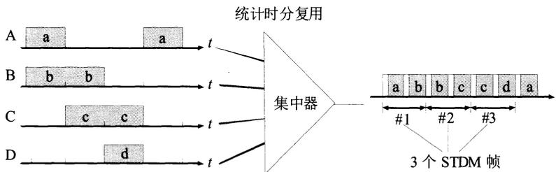
图 2-16 统计时分复用的工作原理
