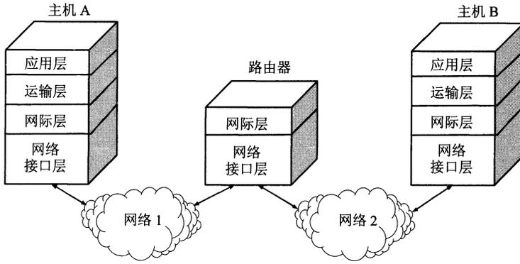
图 1-22 TCP/IP 四层协议的表示方法举例
