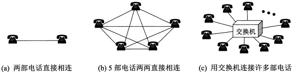
图 1-9 电话机的不同连接方法
