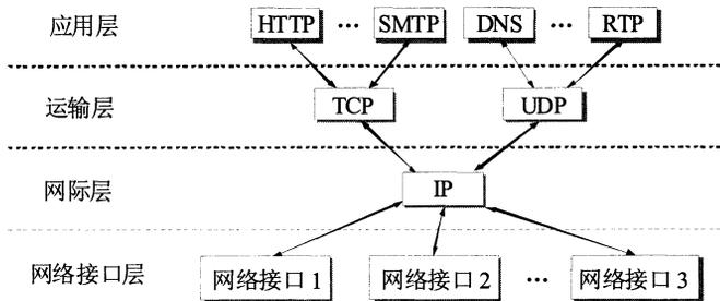
图 1-24 沙漏计时器形状的 TCP/IP 协议族示意
