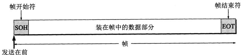
图 3-5 用控制字符进行帧定界的方法举例
