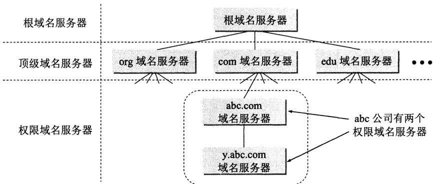
图 6-3 树状结构的 DNS 域名服务器
