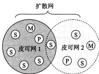
图 9-13 蓝牙系统中的皮可网和扩散网
