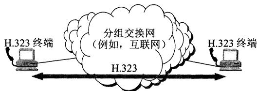
图 8-13 H.323 终端使用 H.323 协议进行多媒体通信
