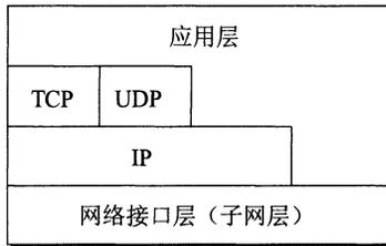
图 1-23 TCP/IP 体系结构的另一种表示方法
