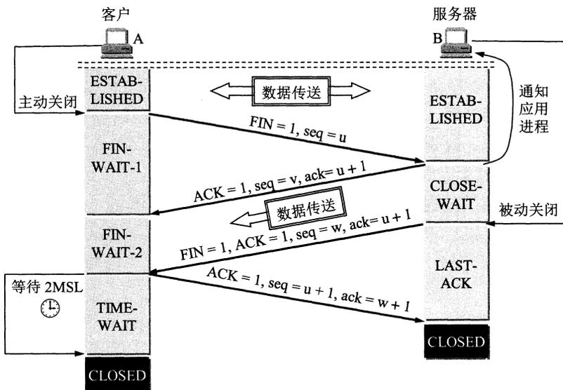
图 5-29 TCP 连接释放的过程
