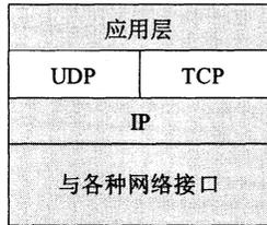
图 5-3 TCP/IP 体系中的运输层协议
