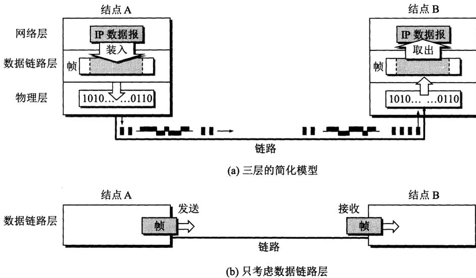
图 3-3 使用点对点信道的数据链路层
