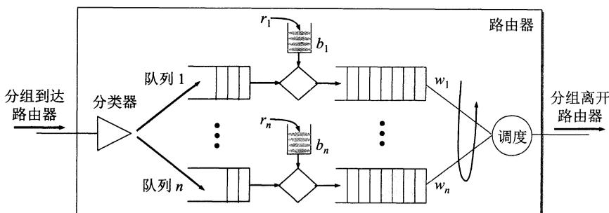
图 8-23 用漏桶机制进行管制
