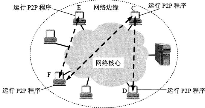
图 1-8 对等连接工作方式（P2P 方式）
