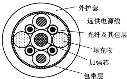
图 2-11 四芯光缆剖面的示意图
