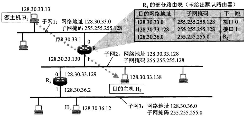
图 4-24 主机 H<sub>1</sub> 向 H<sub>2</sub> 发送分组
