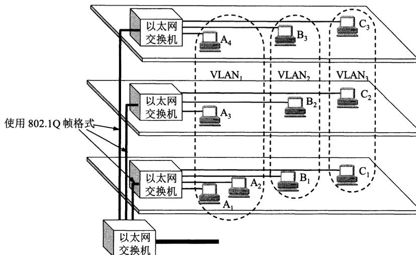
图 3-27 三个虚拟局域网 VLAN<sub>1</sub>, VLAN<sub>2</sub> 和 VLAN<sub>3</sub> 的构成
