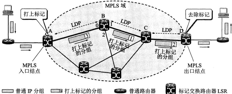
图 4-61 MPLS 协议的基本原理
