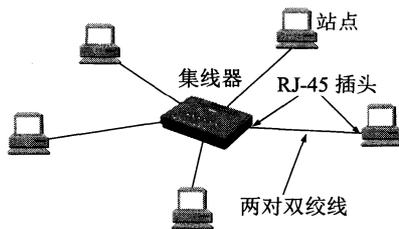
图 3-19 使用集线器的双绞线以太网
