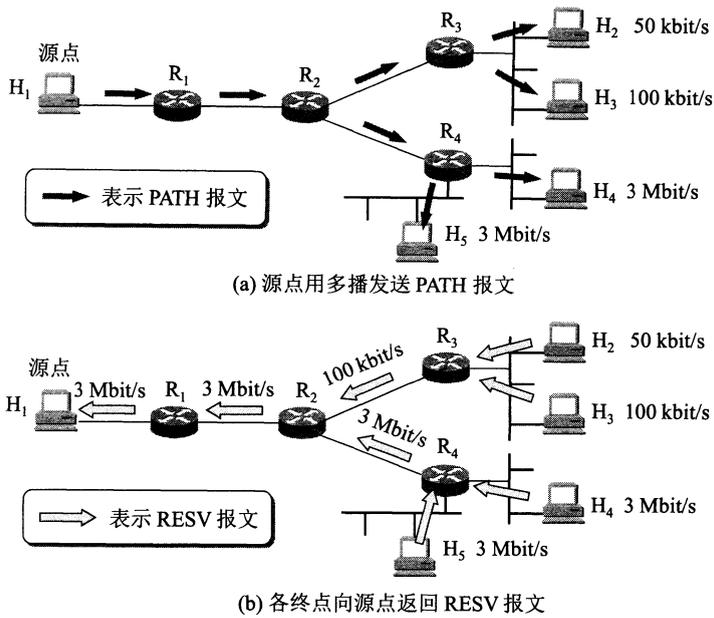
图 8-24 RSVP 协议的工作原理
