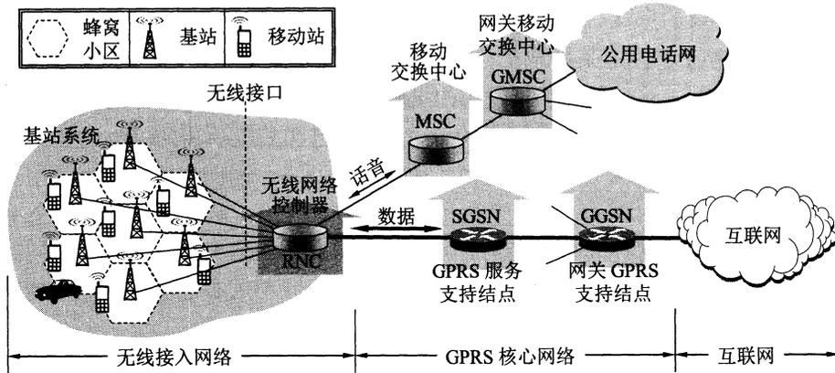
图 9-17 3G 蜂窝通信系统的重要组成构件
