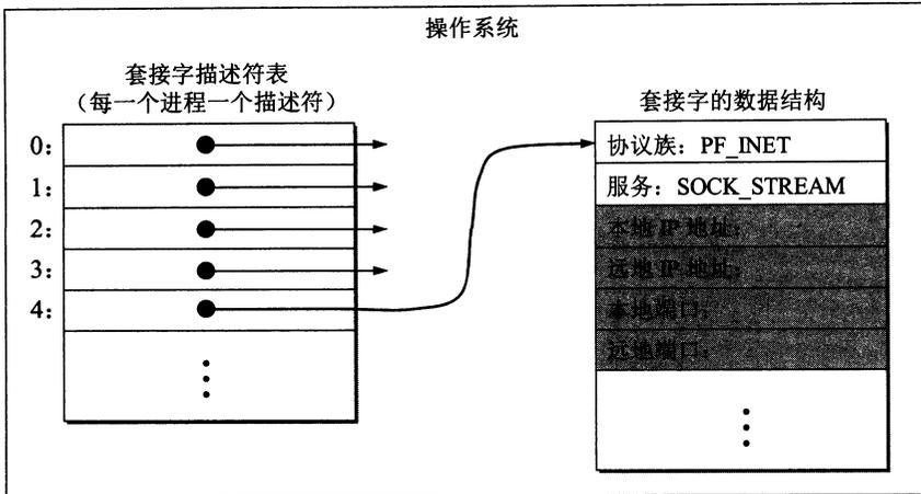
图 6-29 调用 socket 创建套接字
