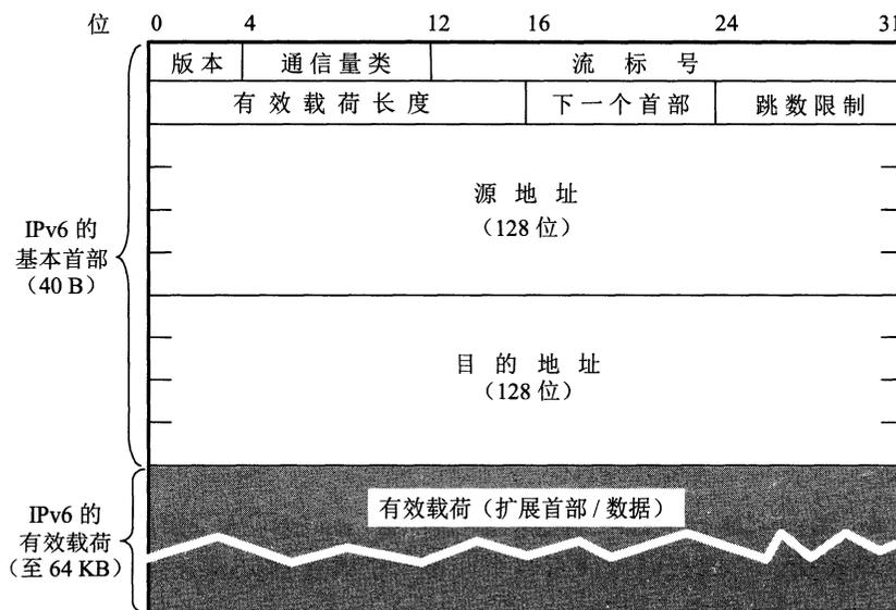
图 4-47 40 字节长的 IPv6 基本首部
