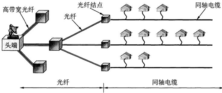
图 2-23 HFC 网的结构图
