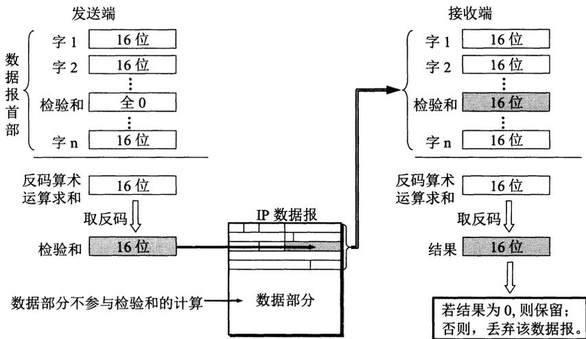
图 4-15 IP 数据报首部检验和的计算过程
