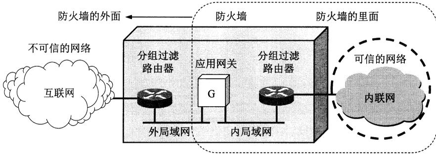
图 7-21 防火墙在互连网络中的位置。
