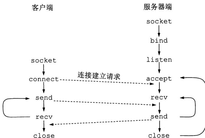
图 6-31 系统调用使用顺序的例子
