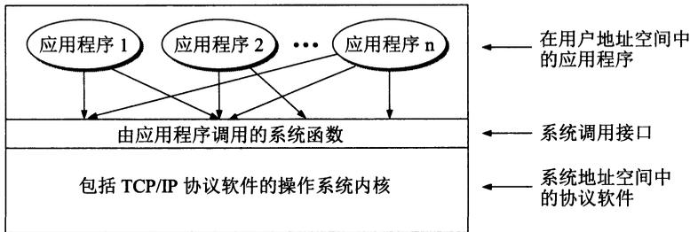
图 6-27 多个应用进程使用系统调用的机制
