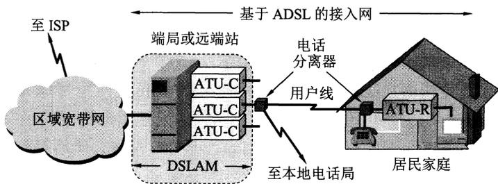
图 2-20 基于 ADSL 的接入网的组成
