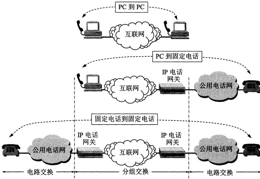
图 8-9 IP 电话的几种连接方法
